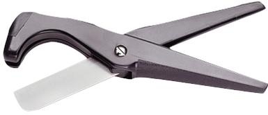
El cortador de mangueras y tubos Dayco puede manejar mangueras y tuberías de caucho no reforzadas y reforzadas con textiles de hasta un diámetro interno de 2" (5 cm). Una hoja de acero inoxidable endurecido reemplazable permite un corte limpio sin rebabas ni residuos. Con un mango de uso seguro de nailon relleno de vidrio resistente con anillo adjunto, este cortador también permite transportarlo fácilmente o colgarlo al exhibidor de mangueras Dayco.
