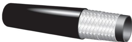
a baja presión, cuenta con un tubo de nitrilo y cubierta de goma sintética negra resistente tanto al aceite como a la intemperie, con una o dos capas de refuerzo trenzado de fibra textil. El margen de temperatura es de -40° F a +212° F (-40 °C a 100 °C). Esta manguera se recomienda para uso con acoplamientos estilos BI y DC.
