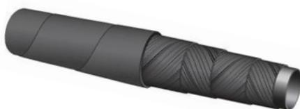
cuenta con una cubierta de hule sintético resistente al aceite y al clima y aprobado por MSHA. Cuatro capas en espiral de alambre de acero de alta tensión proporcionan refuerzo a la cubierta y al tubo de hule sintético resistente al aceite. El margen de temperatura es de -40° F a +250° F (-40 °C a 121 °C). La manguera DR15x se ha probado en impulsos a un millón de ciclos, el doble de la cantidad requerida. El acoplamiento recomendado para DR15x es la serie TG.
