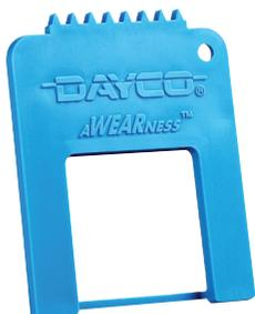
Esta herramienta de bolsillo le ayuda a identificar rápido y fácilmente la posible falla de una banda serpentina simplemente colocando el área ranurada a lo largo de la sección acanalada de la banda. Si la banda tiene más de cuatro grietas por pulgada (2.54 cm), lo recomendable en la industria es cambiar la banda.
