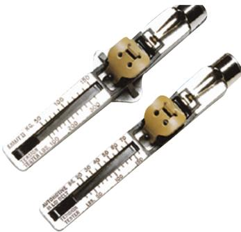
Cuando las bandas no tienen la tensión correcta, se resbalan, chirrían, permiten la acumulación de calor y el desgaste prematuro. Los ingenieros de Dayco recomiendan ajustar la tensión de las bandas cuidadosamente. Después de instalar una banda nueva, encienda el motor y déjelo andar durante 3 a 5 minutos para que la banda se asiente.
