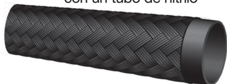
y cubierta trenzada de fibra textil impregnada resistente al aceite y al moho, con una sola capa de refuerzo trenzado de fibra textil. El margen de temperatura es de -40° F a +200° F (-40 °C a 93.3 °C) (160° F [71.1 °C] en aplicaciones gaseosas). Esta manguera se recomienda para uso con acoplamientos estilos PO y BI.
