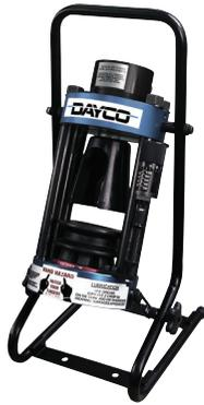
El engarzador Dayco se puede personalizar fácilmente con bombas y moldes opcionales y un estuche para los dados. El D100S aplica 35 toneladas de fuerza a través de once juegos de dados opcionales para permitir el prensado de mangueras de uno y dos alambres de hasta 1” (2.5 cm) de D.I. y mangueras de 4 alambres espirales de hasta 1” (2.5 cm) de D.I.
