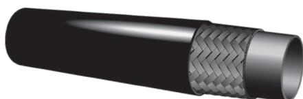
agua a baja presión y cuenta con un tubo de nitrilo y cubierta de goma sintética negra resistente tanto al aceite como a la intemperie, con una o dos capas de refuerzo trenzado de fibra textil. El margen de temperatura es de -40 °F a +212 °F (-40 °C a 100 °C).
