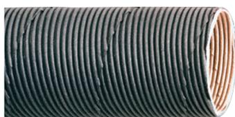
Esta manguera fue diseñada para conectar el limpiador de aire al colector de gases para impedir que el carburador se congele en climas fríos y cuenta con un núcleo de aluminio flexible y de servicio pesado, y construcción corrugada que se puede cortar fácilmente con un cuchillo filoso al tamaño adecuado necesario para encajar entre el limpiador de aire y el colector de gases. La mínima tolerancia del diámetro interno proporciona un ajuste ceñido para reducir el congelamiento del carburador.
