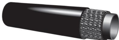
tubo de nitrilo y cubierta de neopreno aprobado por MSHA con una capa de refuerzo trenzado de fibra textil. El margen de temperatura es de -40 °F a +212 °F (-40 °C a 100 °C). Esta manguera se recomienda para uso con acoplamientos estilo
