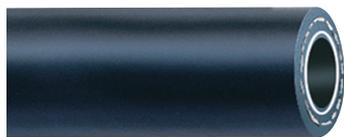
La manguera Dayco de barrera para refrigerante estilo BH/DBH, diseñada únicamente para uso con sistemas refrigerantes R12 and R134A cuenta con construcción de tubo de nitrilo/barrera de nylon/neopreno, refuerzo textil, y cubierta negra de EPDM resistente a abrasiones, ozono y calor. Cumple o excede los requisitos de SAE J2064 (excede J51) tipo C. El margen de temperatura es de -22° F (-5.55° C) a +203° F (95° C). Esta manguera se recomienda para uso con acoplamientos Dayco estilo BL y SB.
