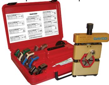
Beadlock para uso con llave neumática e incluye el engarzador ligero tipo burbuja Dayco 3710 y seis dados estándar codificados por color en un conveniente estuche. El engarzador Dayco 3710 produce un engarce seguro de 100 PSIG, tipo triple burbuja en mangueras con trenzado doble. Únicamente para manguera BH/DBH.
