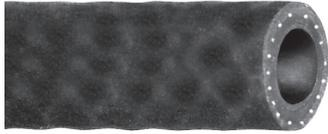
La manguera Dayco Dayperm II es una manguera de hule en capas con baja permeabilidad recomendada para aplicaciones de carburación en motores pequeños y en vehículos más viejos carburados que usan combustibles líquidos. Esta manguera cumple con todos los requisitos de SAE J30R14T2 y con CARB y EPA. Esta manguera Dayperm II es compatible con combustibles con plomo, sin plomo y gasohol al igual que con combustible biodiesel y gasolina combinada con etanol.
