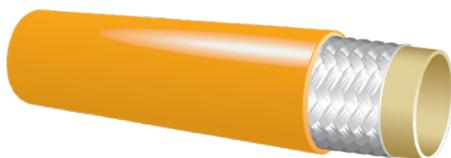
y cubierta de poliuretano anaranjado sin poros, resistente a la abrasión y una capa de refuerzo trenzado de fibra de poliéster. El margen de temperatura es de -40° F a +200° F (-40 °C a 93.3 °C).
