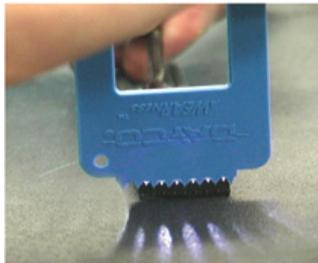
Lorsqu'on place l'indicateur de profil des stries sur une courroie *neuve*, il n'y a pas de jeu sur les côtés ou sur les flancs des stries.
