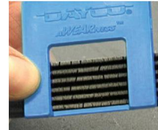
S'il y a quatre fissures ou plus dans la fenêtre, nous recommandons le remplacement.
