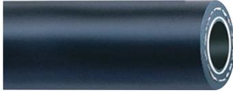
Conçu uniquement pour les systèmes de fluide frigorigène R12 et R134A, le tuyau de fluide frigorigène de style BH/DBH Dayco comporte un tube en nitrile/nylon/néoprène, un renfort textile et une enveloppe en EPDM noir qui résiste à l'abrasion, à l'ozone et à la chaleur. Il est conforme à la norme SAE J2064, type C (et dépasse la norme J51). La fourchette de températures se situe entre -30 °C (-22 °F) et 95 °C (203 °F). Ce tuyau est recommandé pour les raccords Dayco de type BL et SB.
