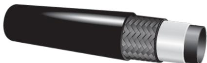
Le tuyau barrière pour fluide frigorigène de style DBH de Dayco comporte un tube en nitrile/barrière de nylon/néoprène, un renfort textile et une enveloppe en EPDM noir qui résiste à l'abrasion, à l'ozone et à la chaleur. Fourchette de températures de -30 °C (-22 °F) à 125 °C (257 °F). Ce tuyau est recommandé avec les raccords de style BL et SB.
