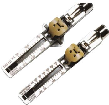
Un mauvais réglage de tension peut causer le glissement, le sifflement, l'accumulation de chaleur et la défaillance prématurée de la courroie. Les ingénieurs de Dayco recommandent de tendre soigneusement la courroie. Lors de la pose d'une nouvelle courroie, il est conseillé de faire tourner le moteur de 3 à 5 minutes pour assurer l'ajustement de la courroie.
