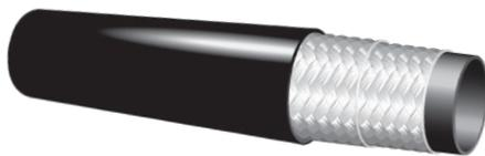
Le tuyau de carburant et d'huile de style DFL de Dayco comporte un tube de nitrile et une enveloppe en caoutchouc synthétique noir qui résiste à l'huile et aux intempéries, ainsi qu'un ou deux renforts de textile tressé. Fourchette de températures de  $-40^{\circ}\text{C}$  ( $-40^{\circ}\text{F}$ ) à  $100^{\circ}\text{C}$  ( $212^{\circ}\text{F}$ ). Ce tuyau est recommandé avec les raccords de style BI et DC.
