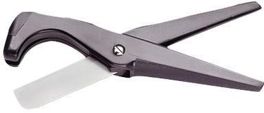
Le coupe-tube Dayco coupe les tuyaux et les tubes de caoutchouc sans renfort et à renfort textile d'un diamètre intérieur allant jusqu'à 2 po. La lame remplaçable en acier inoxydable trempé effectue une coupe nette, sans barbe ni résidu. Le coupe-tube possède une robuste poignée sécuritaire en nylon rempli de verre, et un anneau qui permet de le transporter facilement ou de l'accrocher au présentoir de tuyaux Dayco.
