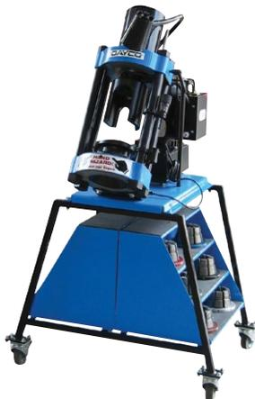
Ce support alliant la sécurité d'une table fixe et la polyvalence d'un modèle à roulettes permet de déplacer de façon sûre et rapide le matériel de sertissage n'importe où dans vos locaux. Le sertisseur D206 de Dayco peut facilement être installé sur ce support à l'aide de quatre boulons de fixation. Doté d'une tablette inférieure, ce support est l'emplacement idéal pour les coffrets de matrices Dayco, afin de créer une installation hydraulique accessible et pratique.
