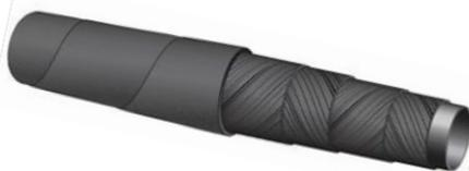
Le renfort est constitué de quatre épaisseurs de fil d'acier haute résistance en spirale. Fourchette de températures de  $-40\text{ }^{\circ}\text{C}$  ( $-40\text{ }^{\circ}\text{F}$ ) à  $121\text{ }^{\circ}\text{C}$  ( $250\text{ }^{\circ}\text{F}$ ). Le tuyau DR15x est soumis à des essais d'impulsion à un million de cycles, soit deux fois le nombre requis, qui est d'un demi-million de cycles. Le raccord recommandé pour le DR15x est la série TG.
