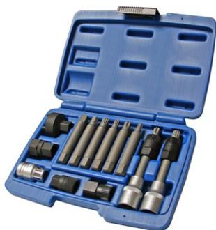
Il est conseillé de déposer la poulie roue libre d'alternateur (OAP) et la poulie de découpleur d'alternateur débrayable (OAD) en utilisant seulement les outils appropriés.
