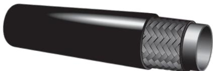
Le tuyau hydraulique de style DR17 de Dayco comporte un tube en caoutchouc synthétique et une enveloppe résistante à l'abrasion. Les Di de 1/4 po, de 3/8 po et de 1/2 po ont un renfort simple d'acier tressé à haute résistance. Les Di de 5/8 po, de 3/4 po et de 1 po ont deux renforts d'acier tressé à haute résistance. Ce tuyau est recommandé avec les raccords des séries DC (grosseurs 4 à 12) et PG (grosseurs 12 à 16).
