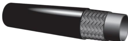
Le tuyau de carburant et d'huile de style D6FL de Dayco comporte un tube de nitrile et une enveloppe en caoutchouc synthétique noir qui résiste à l'huile et aux intempéries, ainsi qu'un ou deux renforts de textile tressé. Fourchette de températures de  $-40^{\circ}\text{C}$  ( $-40^{\circ}\text{F}$ ) à  $100^{\circ}\text{C}$  ( $212^{\circ}\text{F}$ ).
