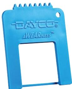
Il suffit de placer le côté cranté de l'outil de poche sur la partie striée de la courroie, dans le sens de la longueur, pour détecter rapidement et facilement tout risque de rupture de la courroie serpentine. S'il y a plus de 4 fentes au pouce dans la courroie, il est recommandé dans le métier de remplacer la courroie.
