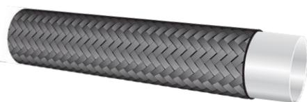
Le tuyau spécial de style DR14 de Dayco comporte un tube extrudé blanc en PTFE à paroi interne lisse. L'enveloppe consiste en une tresse de fils d'acier inoxydable à haute résistance. Fourchette de températures de -53 °C (-65 °F) à 232 °C (450 °F). Pour la vapeur, la pression de service maximum est de 200 psi à 197 °C (388 °F). Ce tuyau est recommandé avec le raccord de style 91N.
