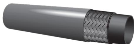
Le tuyau de laveuse à pression DaycoDayBlast<sup>MC</sup> a une construction à un fil qui est spécialement adaptée aux exigences d'aujourd'hui. Ce tuyau comporte une enveloppe de caoutchouc synthétique gris non marquant et un tube en mélange de caoutchouc synthétique et de nitrile. Il peut résister à des températures allant jusqu'à  $148^{\circ}\text{C}$  ( $300^{\circ}\text{F}$ ) et à une pression de service allant jusqu'à 3625 psi. Ce tuyau est recommandé avec les raccords de type DC.
