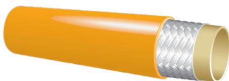
Le tuyau hydraulique de style DR7E de Dayco comporte un tube de thermoplastique et une enveloppe non piquée en polyuréthane orange qui résiste à l'abrasion, avec un renfort simple tressé en fibre de polyester. Fourchette de températures de  $-40\text{ }^{\circ}\text{C}$  ( $-40\text{ }^{\circ}\text{F}$ ) à  $93\text{ }^{\circ}\text{C}$  ( $200\text{ }^{\circ}\text{F}$ ). Ce tuyau est recommandé avec les raccords de style DC et TC.
