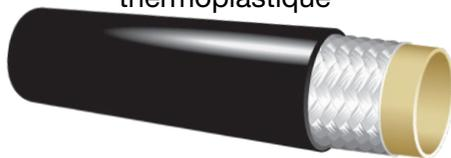
Le tuyau de style DR7 de Dayco comporte un tube de thermoplastique et une enveloppe piquée en polyuréthane noir qui résiste à l'abrasion, avec un renfort simple tressé en fibre de polyester. Fourchette de températures de  $-40\text{ }^{\circ}\text{C}$  ( $-40\text{ }^{\circ}\text{F}$ ) à  $93\text{ }^{\circ}\text{C}$  ( $200\text{ }^{\circ}\text{F}$ ). Ce tuyau est recommandé avec les raccords de style DC et TC.
