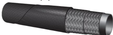
comporte également un renfort double en fil d'acier tressé à haute résistance. Comparativement au tuyau SAE 100R2, le DR16 de Dayco a un rayon de courbure de 50 % plus petit qui convient mieux aux espaces restreints et facilite la configuration du tracé. Fourchette de températures de -40 °C (-40 °F) à 121 °C (250 °F). Ce tuyau est recommandé avec les raccords de style PG et DC.
